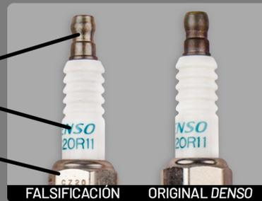
**2** Inspecciona los electrodos de tu bujía: Dependiendo del tipo de bujía (U-Groove, Iridium Power o Iridium TT por ejemplo), los materiales y forma de los electrodos pueden variar, sin embargo la soldadura láser de 360° utilizada por DENSO asegura que los electrodos mantengan su forma y durabilidad perfecta.
