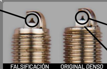
**3** Prueba de raspado: Sin afectar la bujía o su funcionamiento raspando levemente la superficie metálica puedes comprobar la calidad del material de fabricación y que no tenga ningún tipo de recubrimiento.
