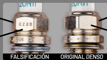
**4** Inspecciona el ángulo del electrodo de masa: su soldadura, material de fabricación y la separación entre electrodos que debe ser consistente e igual entre las diferentes bujías.
